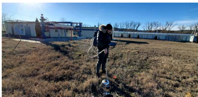
Рис. 7. Проведение измерений почвенного дыхания на территории Ханкальской геотермальной станции с использованием газоанализатора Picarro G4301
